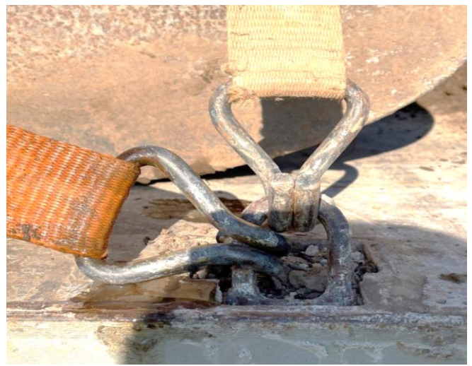
Verwendung mehrerer Haken an einem Zurrpunkt: Dies ist nur erlaubt, wenn der Zurrpunkt (bei zGG über 12 t = 2 000 daN) nicht überlastet wird und die Haken der Zurrgurte korrekt belastet werden.
