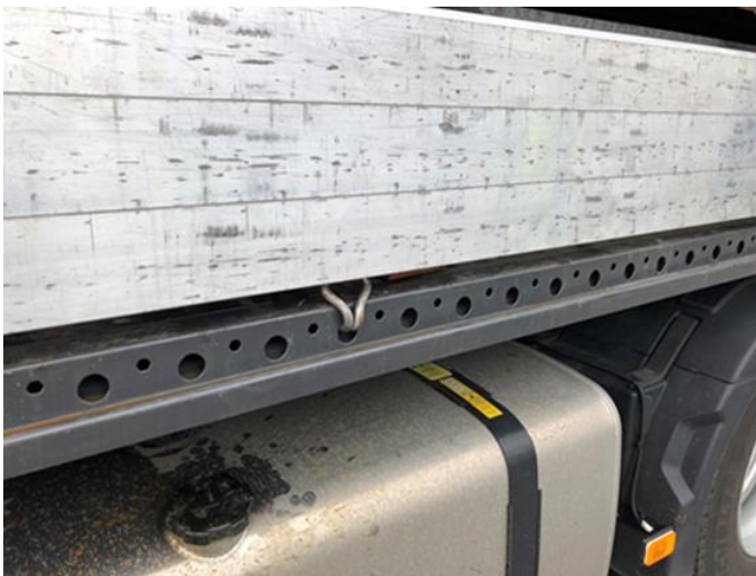
Jede Bohrung im Fahrgestell dient als Zurrpunkt. Maximal 3 Zurrpunkte pro Meter dürfen verwendet werden. Jeder Zurrpunkt hat eine Kapazität von 2 000 daN.
