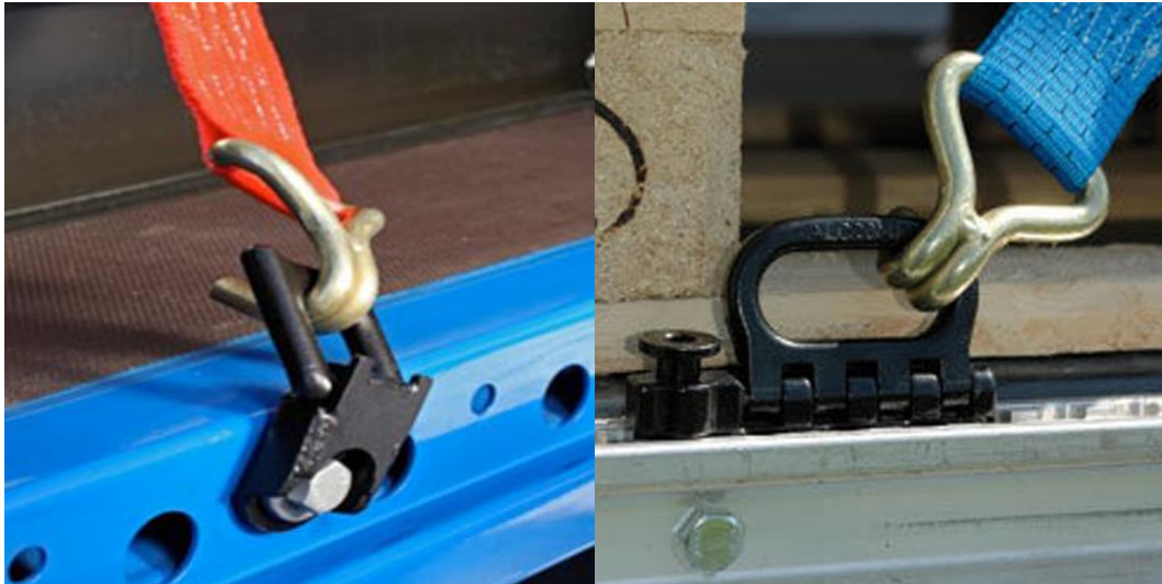
Beispiel für Systeme mit variablen Zurrpunkten
