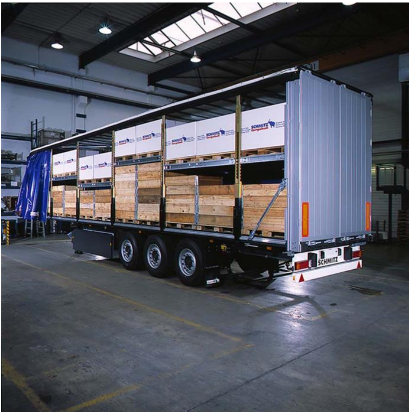
Blocage du chargement par des barres.
