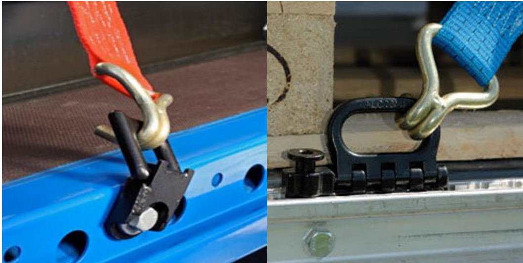
Exemple de systèmes à points d'arrimage variables
