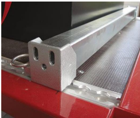
Arrimage de sécurité (Blocage)
