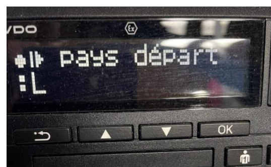
Introduction du symbole de pays (Luxembourg) dans un tachygraphe digital lors d'un passage frontière. Veuillez noter qu'un passage frontière est introduit non avec le pays d'arrivée mais bien avec le pays de départ ! La fonction « pays d'arrivée » n'est utilisée qu'en fin de journée !
