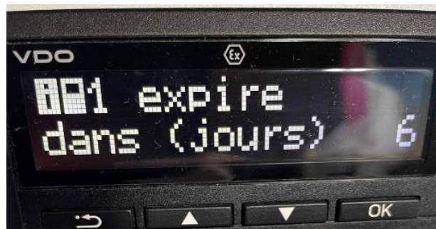
Avertissement du tachygraphe indiquant une carte expirant dans le futur proche (6 jours restants)
